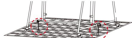
フックを使用して溝の金網に紐で固定する。
