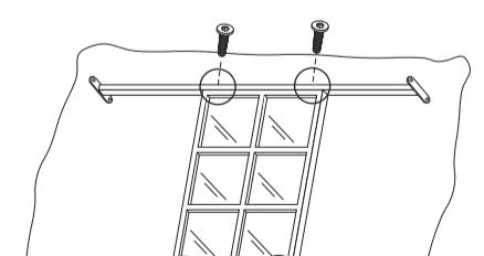
④ 確認後、先ほど仮締めしたすべてのボルトを本締めしてください。
