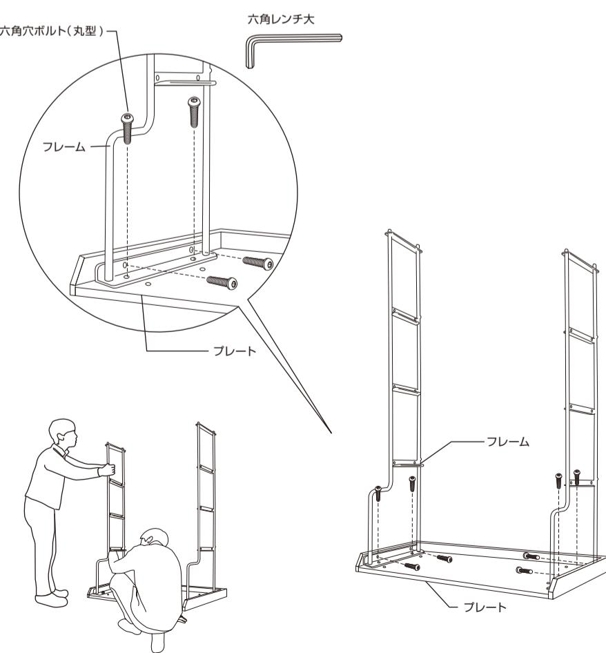
△ この時点でボルトは必ず仮締めの状態にしてください。
