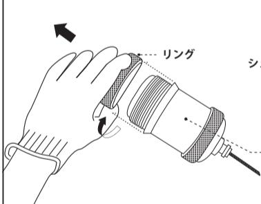
4 固定ネジを左に回しながら外し、ゴムネジ、グリップ、天井カバーの順番に下へさげてください。
