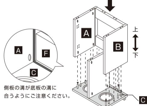
5. 側板A Bと下の補強板Fを底板に取り付ける。
