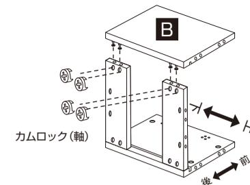
1. 補強板Fの2枚を左側板Bに取付け、補強板Fの端穴にマイナスドライバーでカムロック(軸)を4力所固定する。
