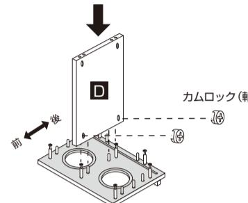
3. 仕切り板Dを底板Cに取付け、仕切り板Dの端穴にマイナスドライバーでカムロック(軸)を2力所固定する。
