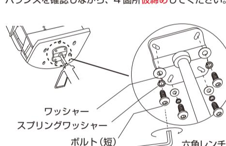
③ ボルトの挿入にゆがみがないか確認し、すべてのボルトを本締めしてください。
