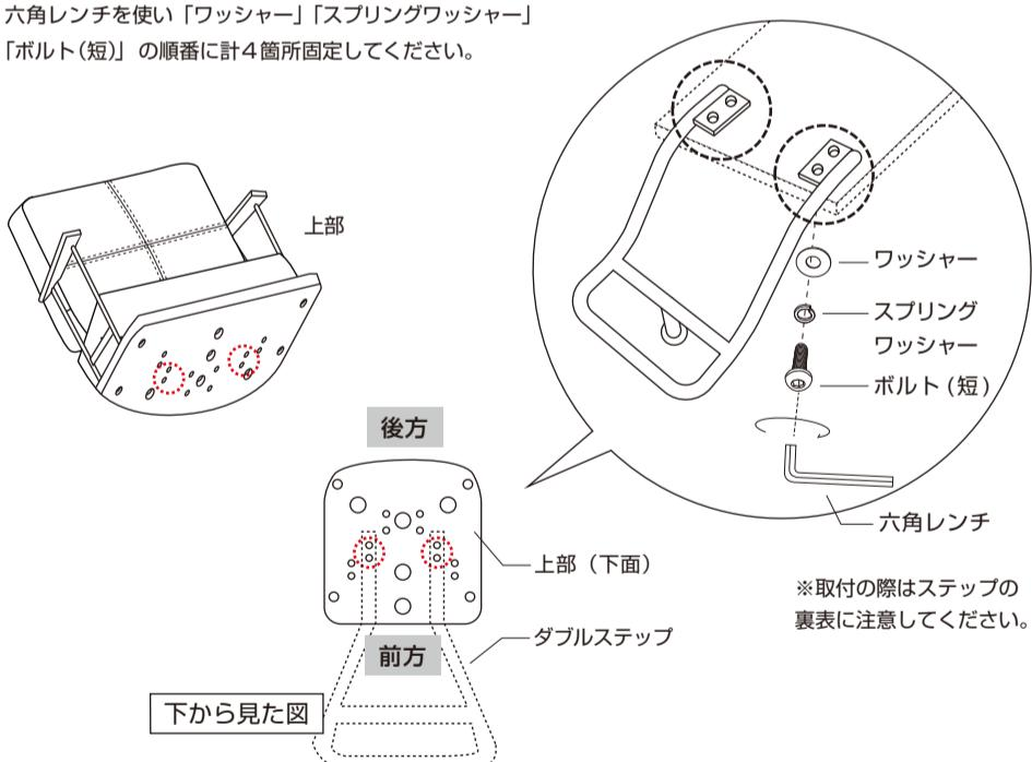
② 六角レンチを使い「ワッシャー」「スプリングワッシャー」「ボルト(短)」の順番に、ボルトが垂直に入るようバランスを確認しながら、4箇所仮締めしてください。
