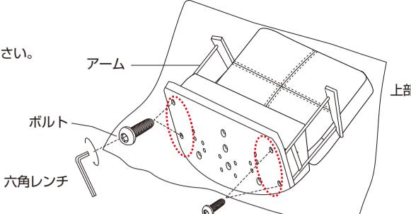
② ステップを上部底面のボルト穴にあわせてください。
