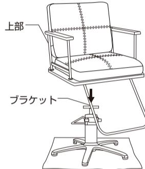
③ ブラケットの前後を確認しながら上部をベースポンプブラケットの上に乗せ、ボルト穴を慎重に合わせて置き、上部が落ちないように一人が固定してください。
