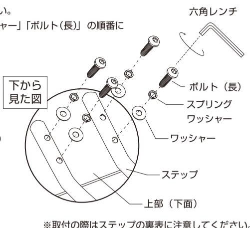
④ 六角レンチを使い「ワッシャー」「スプリングワッシャー」「ボルト(短)」の順番に、ボルトが垂直に入るようバランスを確認しながら、4箇所**仮締め**してください。
