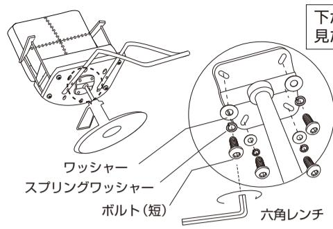
⑤ ボルトの挿入にゆがみがないか確認し、すべてのボルトを**本締め**してください。
