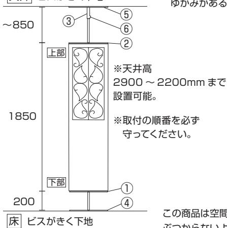
設置後、前後左右に動かして、本体に傾きがないか確認してください。※締込みがゆるい場合や、ゆがみがある状態で使用すると、破損するおそれがあります。
