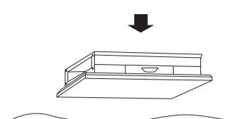
②脚を天板と合せ、天板内側の下穴にジョイントナットを差込み、六角レンチ（大）を使い、脚外側の下穴よりボルト（大）で取付てください。（4脚同様）
