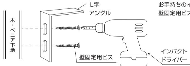
L字アングルの固定穴に、お手持ちのインパクトドライバーを使い、壁固定用ビスで固定してください。
