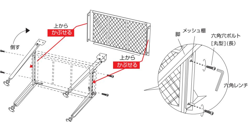
△ この時点でボルトは必ず半締めの状態にしてください。
