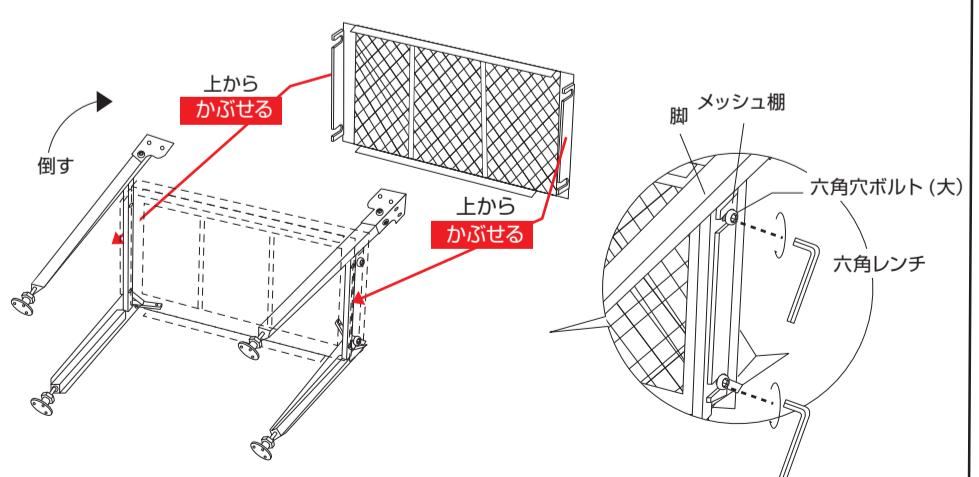
△ この時点でボルトは必ず仮締めの状態にしてください。
