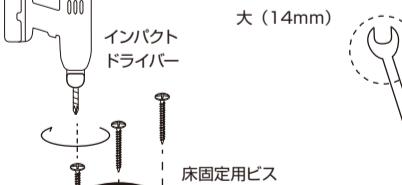
④インパクトドライバーを使い、床固定用ビスで床へ3カ所、4脚とも固定してください。
