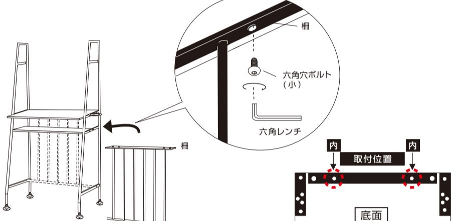
③六角レンチを使い、棚と脚フレームの両サイドを六角穴ボルト(中)で両側2カ所固定してください。
