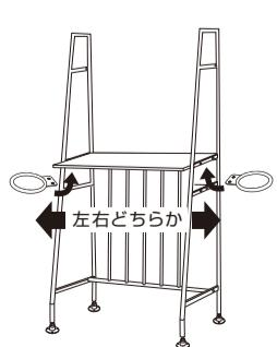
この部分がフラットな方を上面にしてください。溶接跡の凹凸がある方が裏面です。
