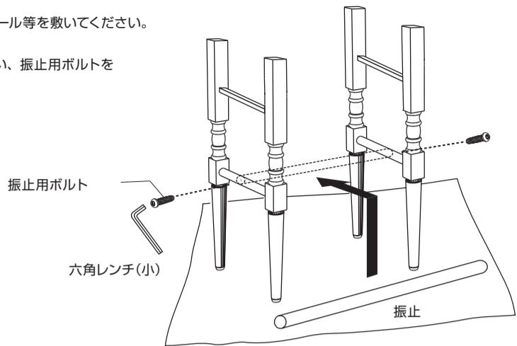
**!** この時点でボルトは必ず半締めの状態にしてください。
