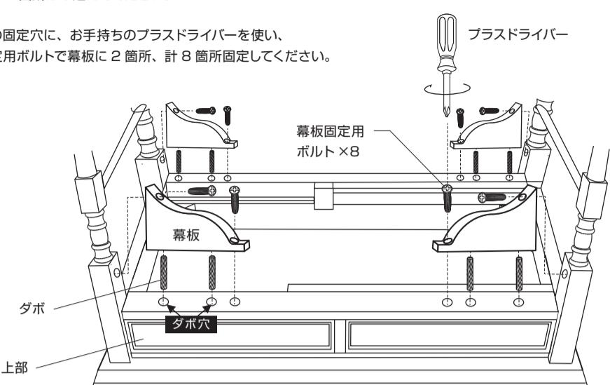
**!** この時点でボルトは必ず半締めの状態にしてください。
