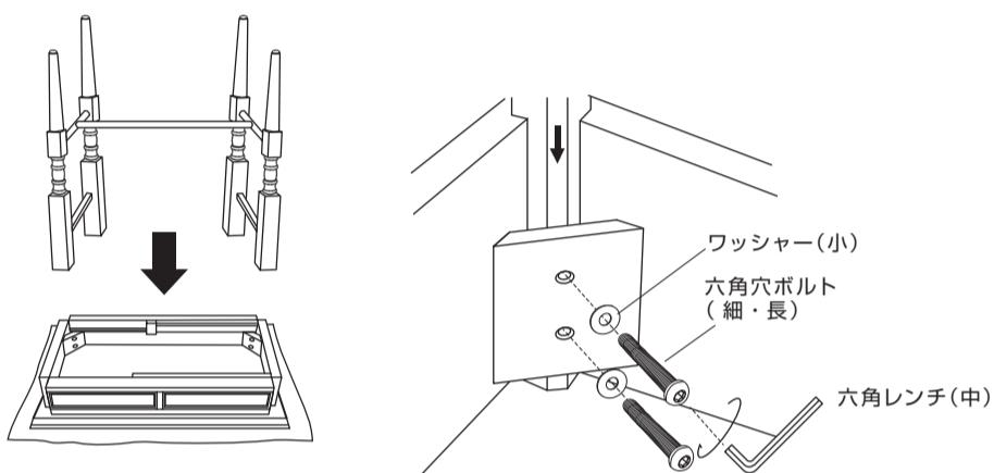
**!** この時点でボルトは必ず半締めの状態にしてください。
