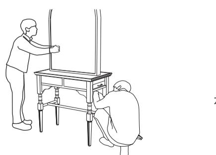
**!** この時点でボルトは必ず半締めの状態にしてください。
